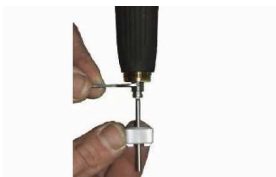
c/ Klíčem přidržel vzkličidlo a současně odšroubovat pomocným nástrojem vzkličidlo a vytáhnout ven.
