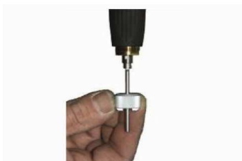
b/ Do vzkličidla vsunout pomocný nástroj
